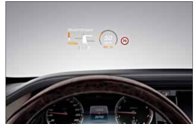
Проекционный дисплей выводит важную информацию непосредственно в поле Вашего зрения.
