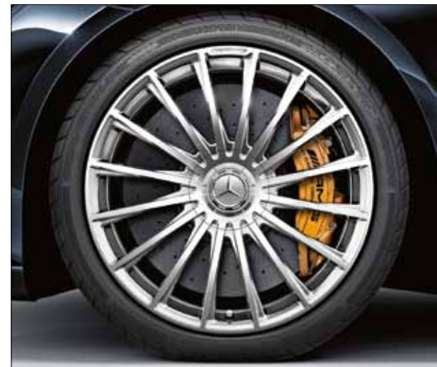
Серийные 20-дюймовые кованые многоспицевые диски и опциональная высокоэффективная композитно-керамическая тормозная система AMG.
