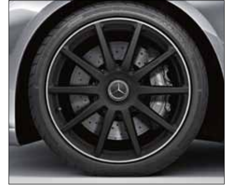
Кованный диск AMG с 10 спицами, матово-черная лакировка, с полированным ободом, шины 255/40 R 20 впереди и 285/35 R 20 сзади (только для моделей Mercedes-AMG, код 648).
