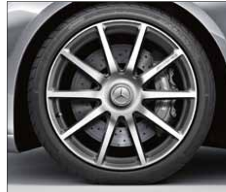
Кованный диск AMG с 10 спицами, «Серый титан», полированный, шины 255/40 R 20 впереди и 285/35 R 20 сзади (только для моделей Mercedes-AMG, код 647).
