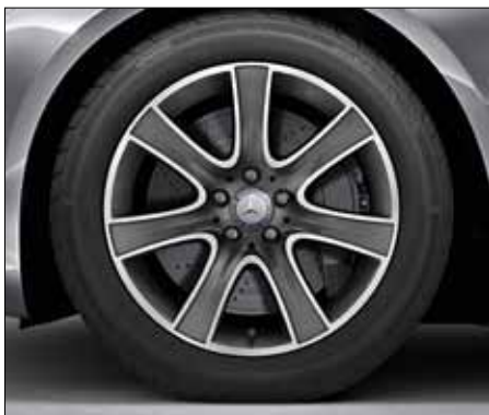
Легкосплавный диск с 7 спицами, шины 245/50 R 18 впереди и 275/45 R 18 сзади (код R72).
