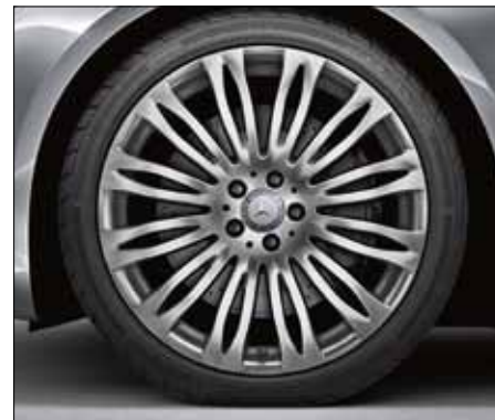
Легкосплавный многоспицевый диск, лакировка «Серебристый тулий», шины 245/40 R 20 впереди и 275/35 R 20 сзади (код 13R).
