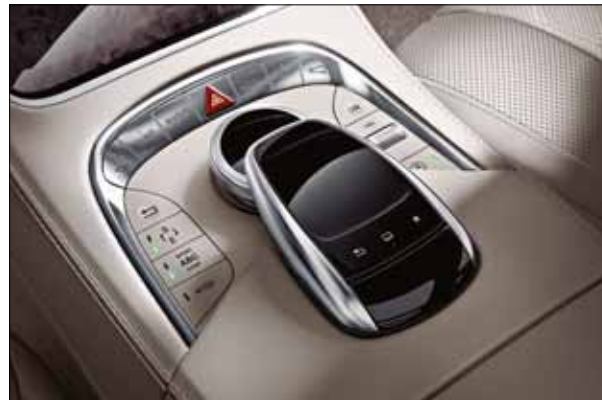
Сенсорная панель позволяет удобно управлять функциями телематики одним или двумя пальцами.
