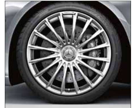
Кованный многоспицевый диск AMG, керамическая глянцево-серая лакировка, полированный, шины 255/40 R 20 впереди и 285/35 R 20 сзади (только для Mercedes-AMG S 65, код 696).
