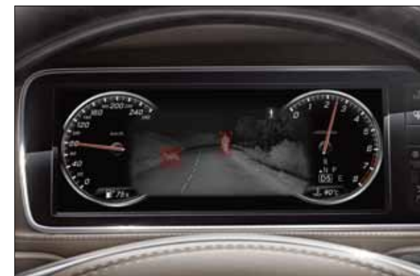
Система ночного видения Plus визуально выделяет пешеходов и помогает водителю быстрее реагировать на опасности в темное время суток.
